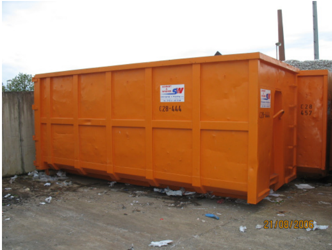
Abrollcontainer mit: 28 m 3 Volumen
