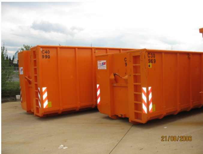
Abrollcontainer mit: 30 m 3 und 40 m 3 Volumen
